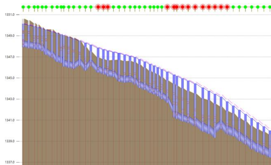
图36. 下游管段能力不足类易涝点
