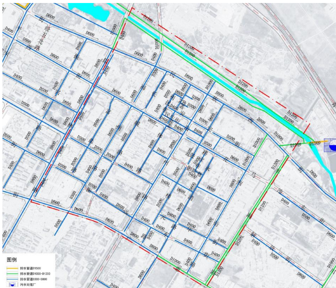
图 2-9 老城区污水管网现状图
