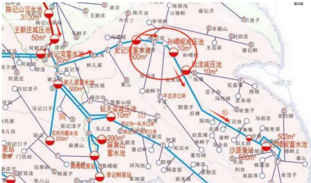
史记湾至后洼支管供水现状图
