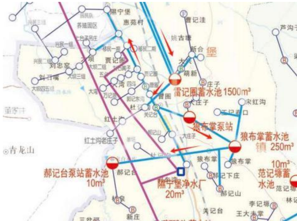
雷记圈蓄水池-狼布掌蓄水池支管供水现状图
