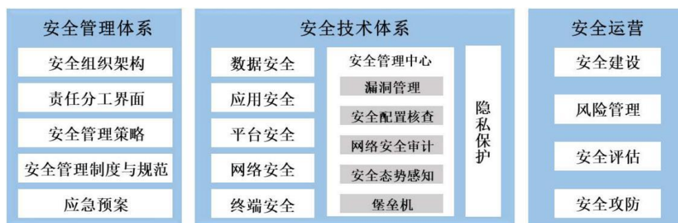
图4.5.5-16系统安全体系架构
