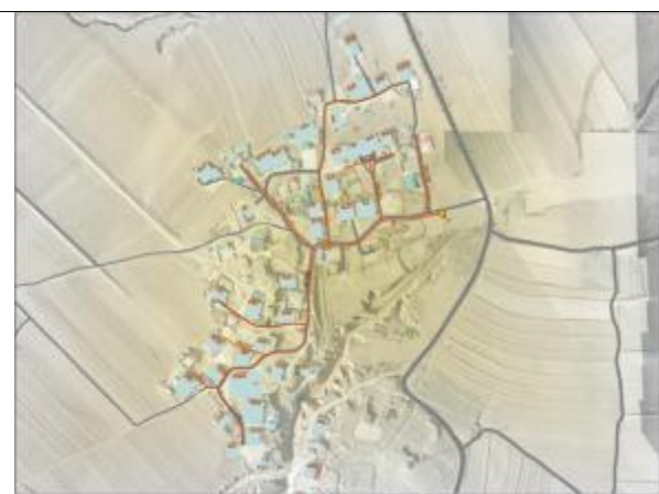
图 9-8 后台污水管网图
